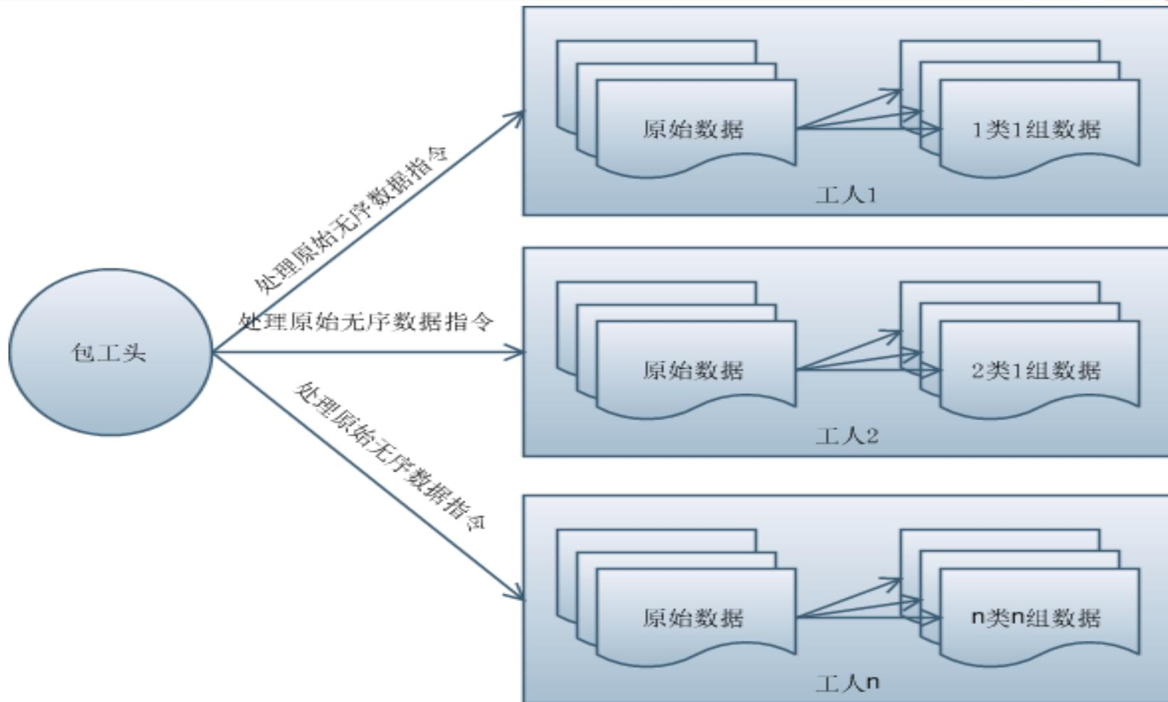
将分散到多台计算机的海量无序数据，按照工人数量和预计处理的每份数据文件大小两个维度分类，计算出每个工人所属的数据范围
