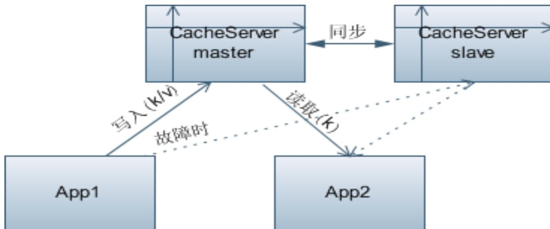
如果对一个中小型的互联网或者企业应用，仅仅利用domain/node进行k/v的存储即可，因为domain/node都是内存操作而且读写锁分离，同时拥有复制备份，完全满足缓存的高性能与可靠性。对于大型互联网应用，高峰访问量上百万的并发读写吞吐量，会超出单台服务器的承受力
