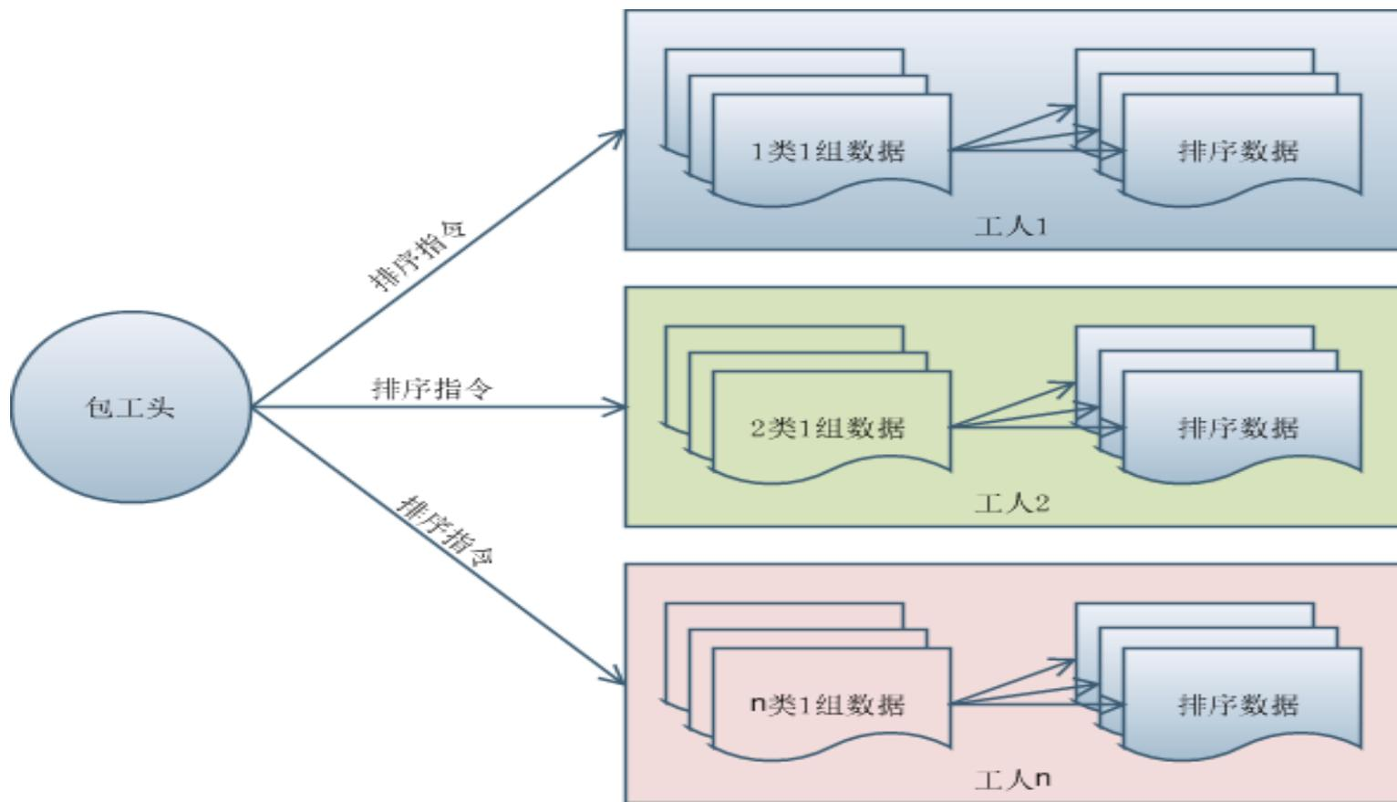
工人对属于自己范围的数据进行排序，最后得到一个整体原始数据的排序结果，但是它是根据范围分散到不同任务计算机上存放的。完成后返回通知包工头完成排序
