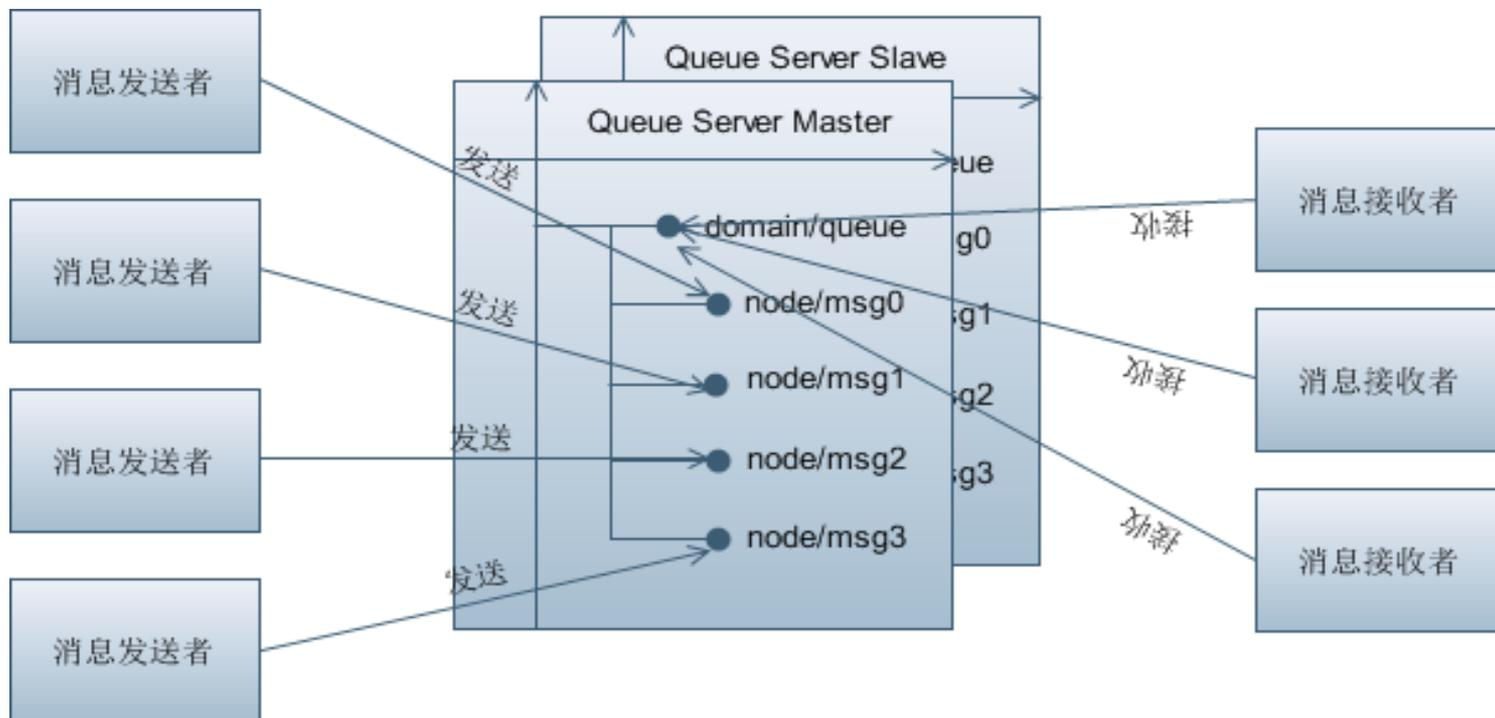
**Fourinone也可以当成简单的mq来使用，发送接收模式实现: 将domain视为mq队列，每个node为一个队列消息，监控domain的变化事件来获取队列消息。**
