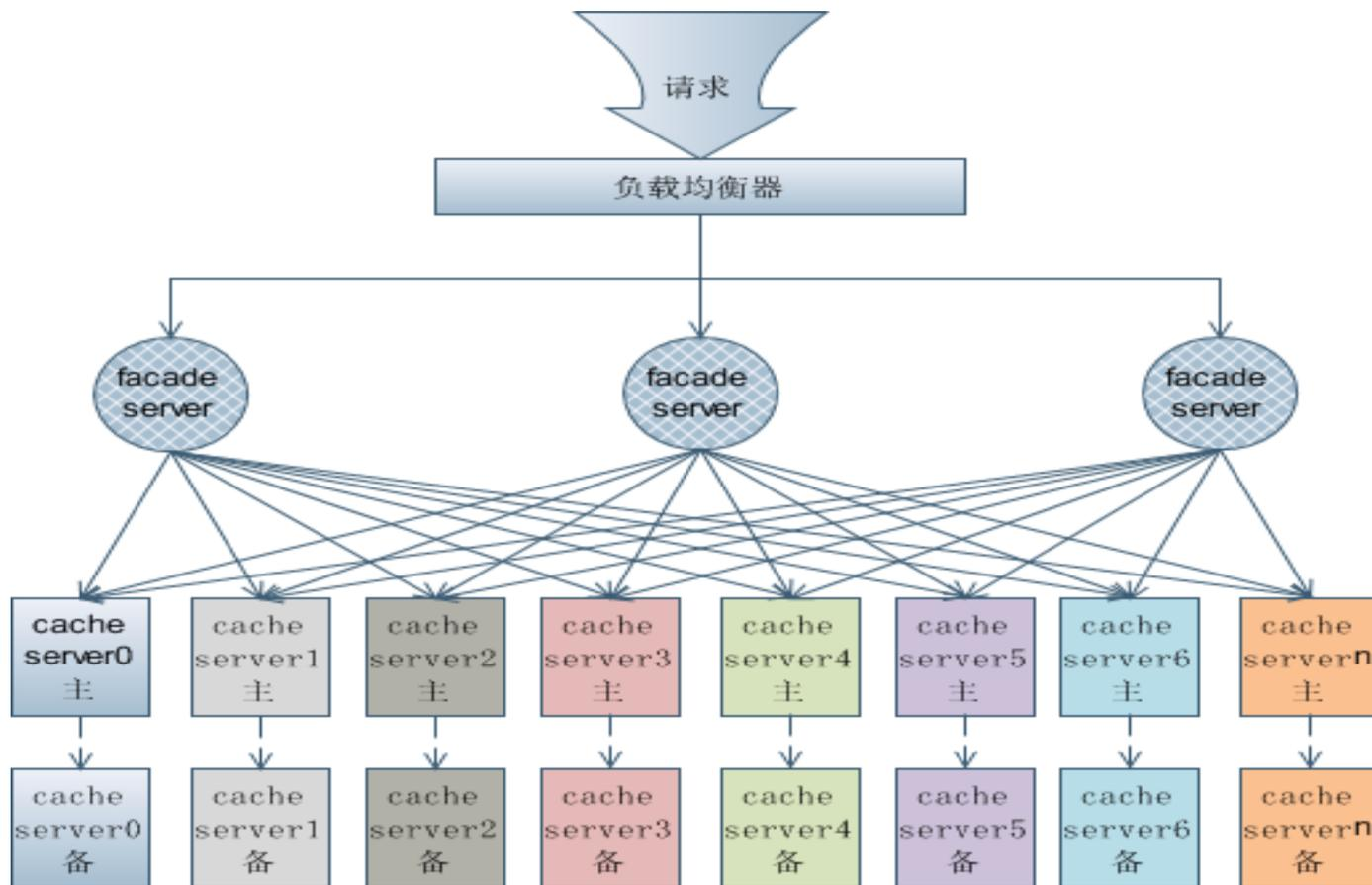
Fourinone提供了facade的解决方案去解决大集群的分布式缓存，利用硬件负载均衡路由到一组facade服务器上，facade可以自动为缓存内容生成key，并根据key准确找到散落在背后的缓存集群的具体哪台服务器，当缓存服务器的容量到达限制时，可以自由扩容，不需要成倍扩容，因为facade的算法会登记服务器扩容时间版本，并将key智能的跟这个时间匹配，这样在扩容后还能准确找到之前分配到的服务器。基于Fourinone可以轻松实现web应用的session功能，只需要将生成的key写入客户端cookie即可。
