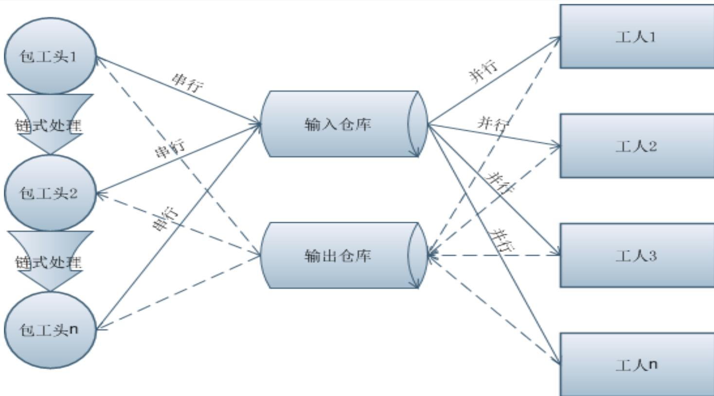
总的来说，是将大数据的复杂分布式计算，设计为一个链式的多“包工头”环节去处理，每个环节包括利用多台“农民工”机器进行并行计算，无论是拆分计算任务还是合并结果，都可以设计为一个单独的“包工头”环节。这样做的好处是，开发者有更大能力去深入控制并行计算的过程，去保持使用并行计算实现业务逻辑的完整性，而且对各种不同类型的并行计算场景也能灵活处理，不会因为某些特殊场景被map/reduce的框架限制住思维，并且链式的每个环节也方便进行监控过程。
