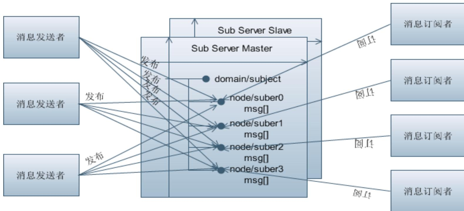
将domain视为订阅主题，将每个订阅者注册到domain的node上，发布者将消息逐一更新每个node，订阅者监控每个属于自己的node的变化事件获取订阅消息，收到后清空内容等待下一个消息，多个消息用一个arraylist存放
