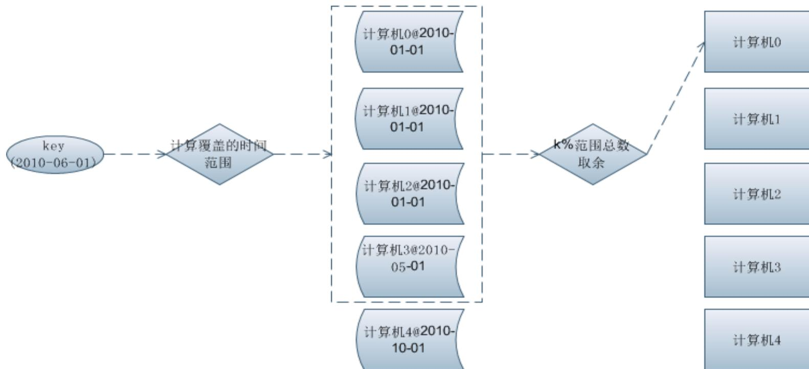
传统key取模这种方式有很大的缺陷，当集群数量扩充时，取模变的不准确，如果要维持准确，通常成倍方式去扩容，会造成成本增加和浪费。本发明通过生成含有日期信息的key，并对集群扩容增加日期配置，通过key和集群配置的日期匹配计算出覆盖范围的机器数，再取模的方式准确得到负载的计算机，对于集群的任意数量的扩容都不会受到影响。
